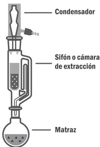
El material de vidrio para la metodología Soxhlet está constituido por la integración de un matraz que contiene el disolvente extractor y el aceite que se extrae; un sifón o cámara de extracción donde se deposita la muestra que es objeto de la determinación; y un condensador que lleva a cabo la condensación del disolvente para su posterior depósito en el citado sifón.
